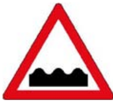
Uneven Roadway Sign
